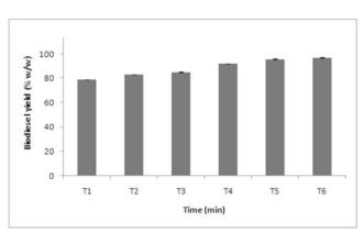
Reaction time: T1-30 min, T2-60 min, T3-90 min, T4-120 min, T5-150 min, T6-180 min
