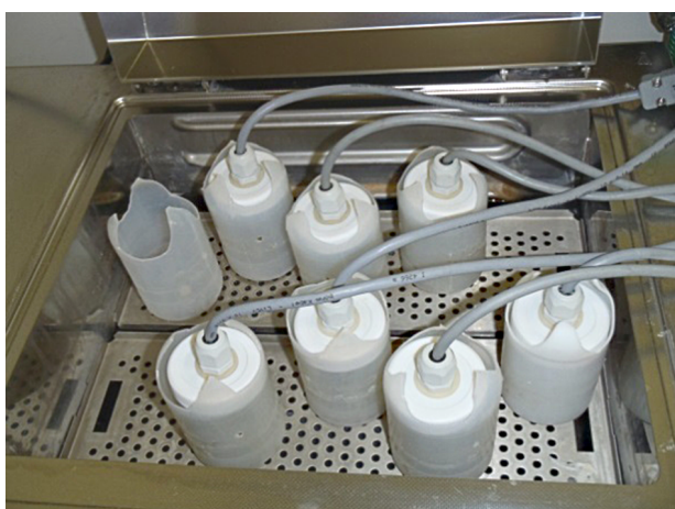
Obr. 3. Uspořádání skleněných nádobek v termostatické lázni během rezistometrického měření za podmínek Oddy testu při 50 °C a 80 % relativní vlhkosti
