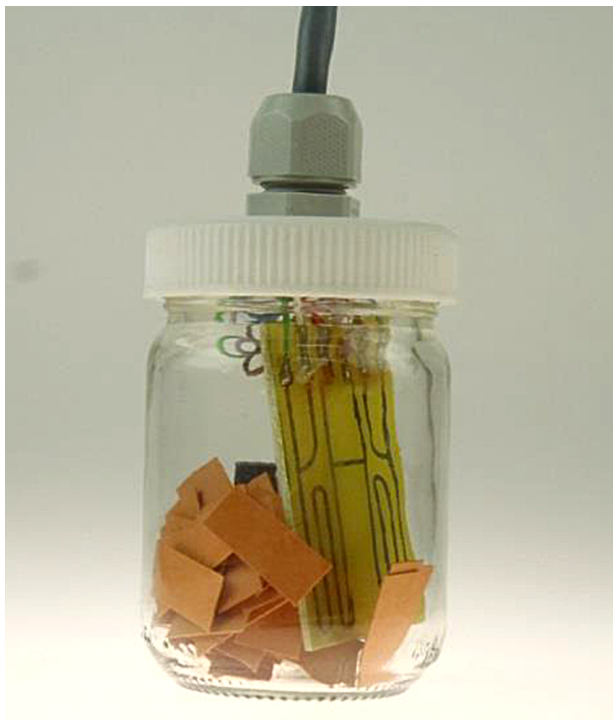
Obr. 2. Uzavřená skleněná nádobka s ampulkou naplněnou roztokem (NH_4)_2SO_4 , olověným kupónem a olověným rezistometrickým senzorem převrstvenými nastříhaným obalovým materiálem
