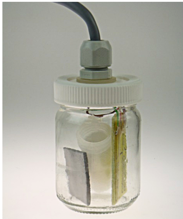
Obr. 1. Uzavřená skleněná nádobka s ampulkou naplněnou roztokem (\text{NH}_4)_2\text{SO}_4 , oloveným kupónem a oloveným rezistometrickým senzorem
