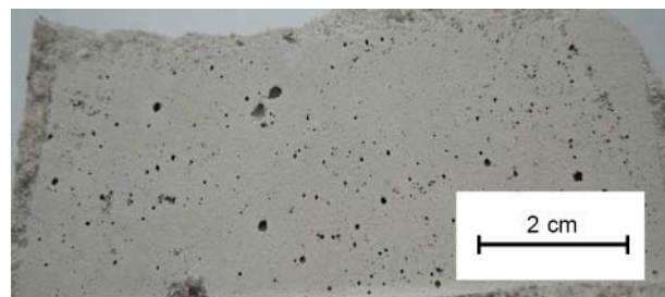
Obr. 5. Makroskopický snímek cementového tmelu z fázového rozhraní nelegovaná ocel/cementový tmel (4 měsíce zrání) – 95 % RH
