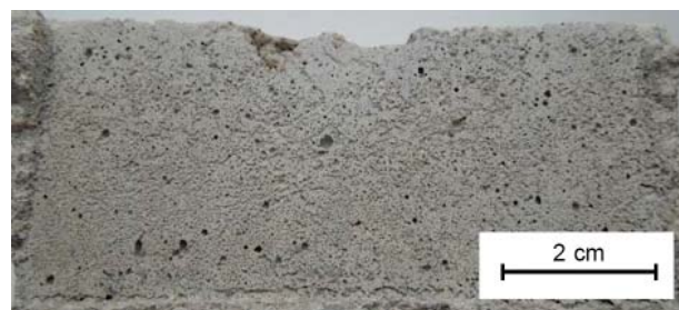
Obr. 6. Makroskopický snímek cementového tmelu z fázového rozhraní žárově zinkovaná ocel/cementový tmel (4 měsíce zrání) – 95 % RH
