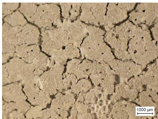
Obr. 13. Porézní struktura cementového tmelu odebraného z fázového rozhraní v blízkosti žárově zinkované oceli – uložení pod vodní hladinou
