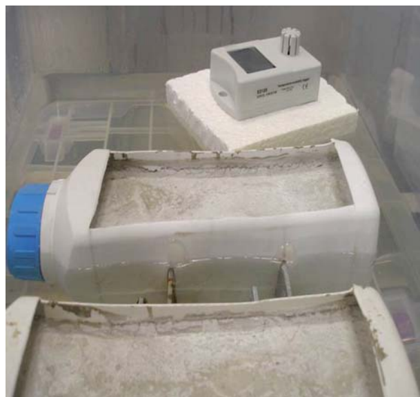
Obr. 2. Uložení forem vzorků cementové pasty do vlhkého prostředí plastového boxu s umístěným vlhkoměrem
