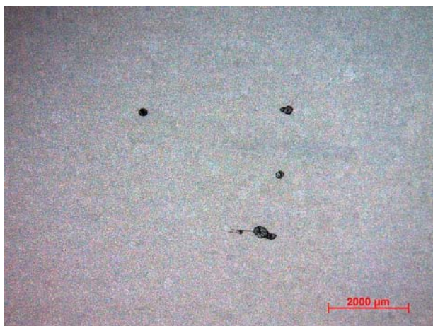
Obr. 5. Povrch vzorky po potenciodynamickej skúške koróznej odolnosti napadnutý pittingom (8 hod ponoru v tavenine Na[BF 4 ] pri teplote 450 °C)
