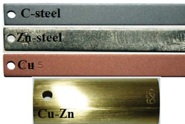
Obr. 1. Korózne kupóny C-steel, Zn-steel, Cu a Cu-Zn Fig. 1. Corrosions coupons C-steel, Zn-steel, Cu and Cu-Zn
