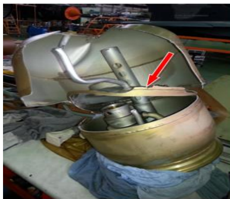
Rys.4a Częściowe rozerwanie spawu korpusu hydroakumulatora
