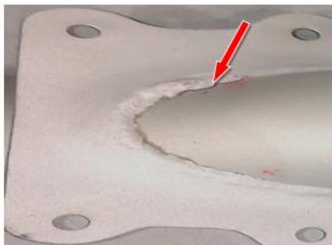
Rys.3b Pęknięcie spawu w węźle uzbrojenia
