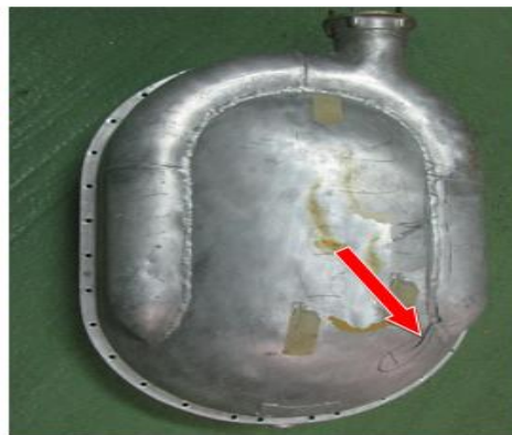
Rys.4b Pęknięty spaw zbiornik-akumulator płynu
