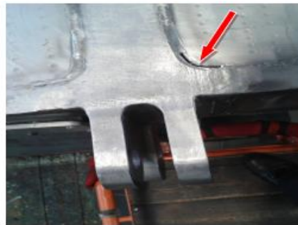
Rys.2b Nieszczelność na spawie skrzydłowego zbiornika paliwowego
