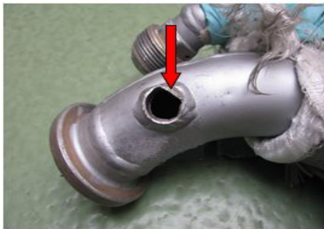
Rys.2a Urwany króciec przewodu instalacji klimatyzacji w SWC (strefie wpływu ciepła)
