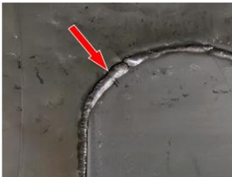
Rys.3a Pęknięcia spawów otworów rewizyjnych zbiornika paliwowego
