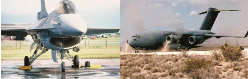
Rys. 5. Wiry, które zasysają do silników ciała obce
