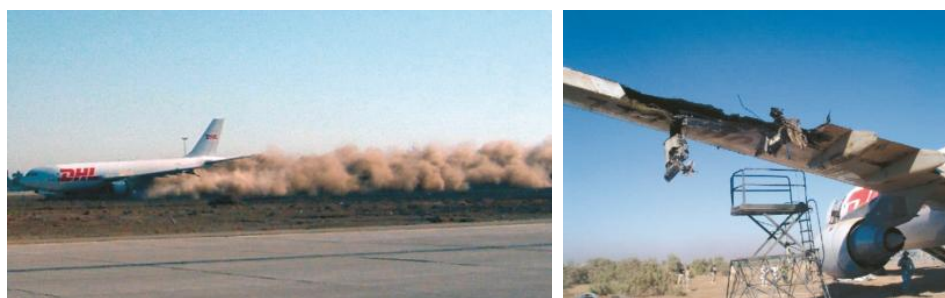
Rys. 4. Lądowanie samolotu A-300 z uszkodzonym skrzydłem
