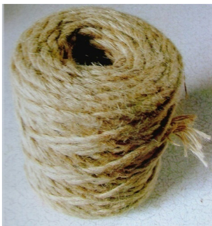
Figure 13. Hemp fibre rope Rysunek 13. Sznur z włókien konopnych Source: Allin 2012. Źródło: Allin 2012.
