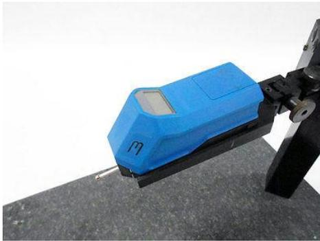
Fig. 7. Stylus profile meter T500 HommelWerke
