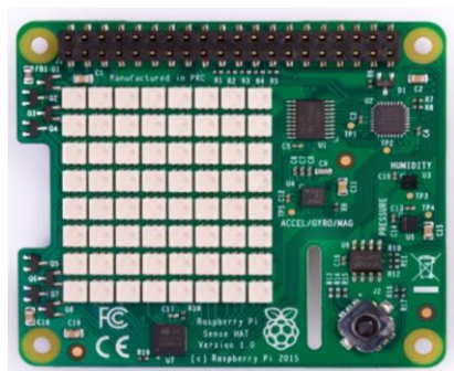
Figure 6. Sense Hat Shield
