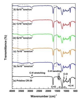
Fig. 4. FT-IR spectra of (a) pristine and implanted CR-39 with 400 keV Au<sup>+</sup> ion beam at (b)  $5 \times 10^{13}$  ions/cm<sup>2</sup> (c)  $1 \times 10^{14}$  ions/cm<sup>2</sup> (d)  $5 \times 10^{14}$  ions/cm<sup>2</sup> (e)  $1 \times 10^{15}$  ions/cm<sup>2</sup> (f)  $5 \times 10^{15}$  ions/cm<sup>2</sup>.
