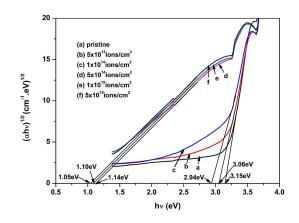
Fig. 7. Plots of  $(\alpha h \upsilon)^{1/2}$  vs. (h $\upsilon$ ) to determine optical band gap energy of CR-39 polymer (a) pristine and implanted at 400 keV to (b) 5 × 10<sup>13</sup> Au<sup>+</sup> ions/cm<sup>2</sup>, (c) 1 × 10<sup>14</sup> Au<sup>+</sup> ions/cm<sup>2</sup>, (d) 5 × 10<sup>14</sup> Au<sup>+</sup> ions/cm<sup>2</sup>, (e) 1 × 10<sup>15</sup> Au<sup>+</sup> ions/cm<sup>2</sup>, (f) 5 × 10<sup>15</sup> Au<sup>+</sup> ions/cm<sup>2</sup>.
