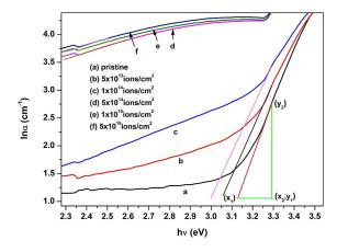
Fig. 9. Plots of  $\ln(\alpha)$  vs. (hv) to determine Urbach energy of CR-39 (a) pristine and implanted at 400 keV to (b)  $5 \times 10^{13}$  Au<sup>+</sup> ions/cm<sup>2</sup>, (c)  $1 \times 10^{14}$  Au<sup>+</sup> ions/cm<sup>2</sup>, (d)  $5 \times 10^{14}$ Au<sup>+</sup> ions/cm<sup>2</sup>, (e)  $1 \times 10^{15}$  Au<sup>+</sup> ions/cm<sup>2</sup>, (f)  $5 \times 10^{15}$  Au<sup>+</sup> ions/cm<sup>2</sup>.
