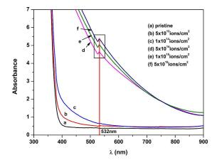
Fig. 6. UV-Vis absorption spectra of CR-39 (a) pristine and implanted at 400 keV to (b)  $5 \times 10^{13}$  Au<sup>+</sup> ions/cm<sup>2</sup>, (c)  $1 \times 10^{14}$  Au<sup>+</sup> ions/cm<sup>2</sup>, (d)  $5 \times 10^{14}$  Au<sup>+</sup> ions/cm<sup>2</sup>, (e)  $1 \times 10^{15}$  Au<sup>+</sup> ions/cm<sup>2</sup>, (f)  $5 \times 10^{15}$  Au<sup>+</sup> ions/cm<sup>2</sup>.
