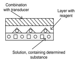
Fig. 1. Biosensor scheme [15].
