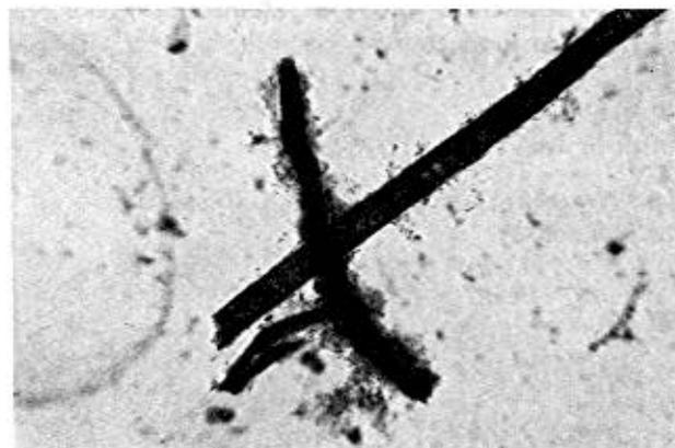
i) Folie mit Bindemittel. Anfärbung mit Chlorzinkjodlösung. Seitlich angefaserte Tabakrippe, Kiefernzellstoff.
