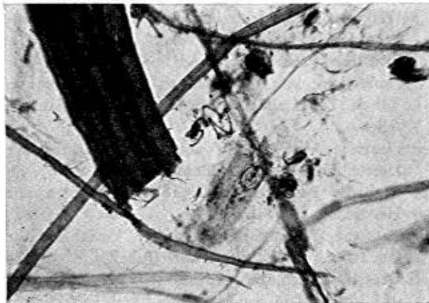
h) Folie ES mit Fremdzellulose (5). Anfärbung mit Chlorzinkjodlösung. Tabakrippe, Buchenzellstoff: Gefäßglied und Sklerenchymfasern.
