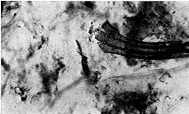
**a)** Folie ohne Bindemittel. Gut erhaltenes Rippenpaltstück, Rest eines Spiralgefäßes, Rest eines quer geschnittenen Rippenstückes, im übrigen zerfaserte Rippen und vermahlene Blattanteile. Ohne Anfärbung.
