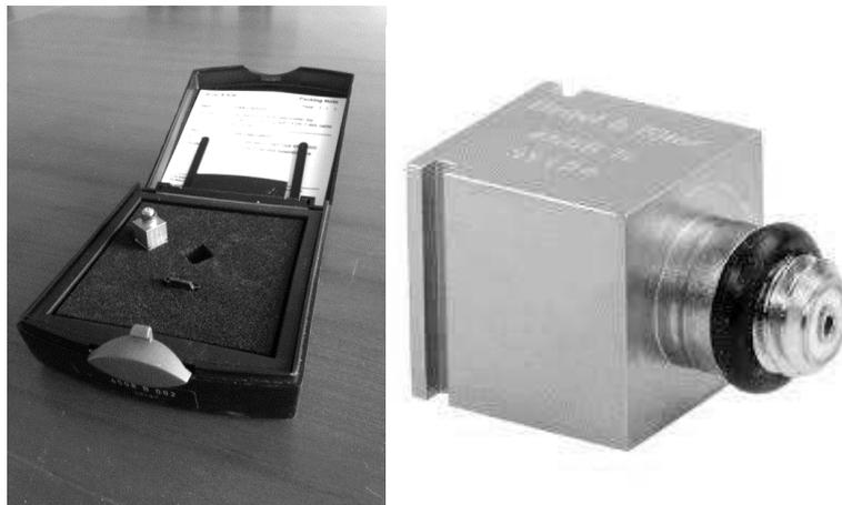
Fig. 5: Piezoelectric accelerometer BK 4508 B 002, [13].
